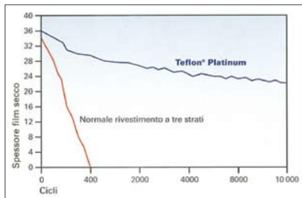
Indice dei cicli di durata con un peso di 1,5 Kg - Length of cycle indicator with a 1.5 kg weight - Index des cycles de durée Avec un poids de 1.5 kg - Lebensdauerindex mit einem Gewicht von 1,5 kg - Índice de los ciclos de duración: con un peso de 1,5 kg.
